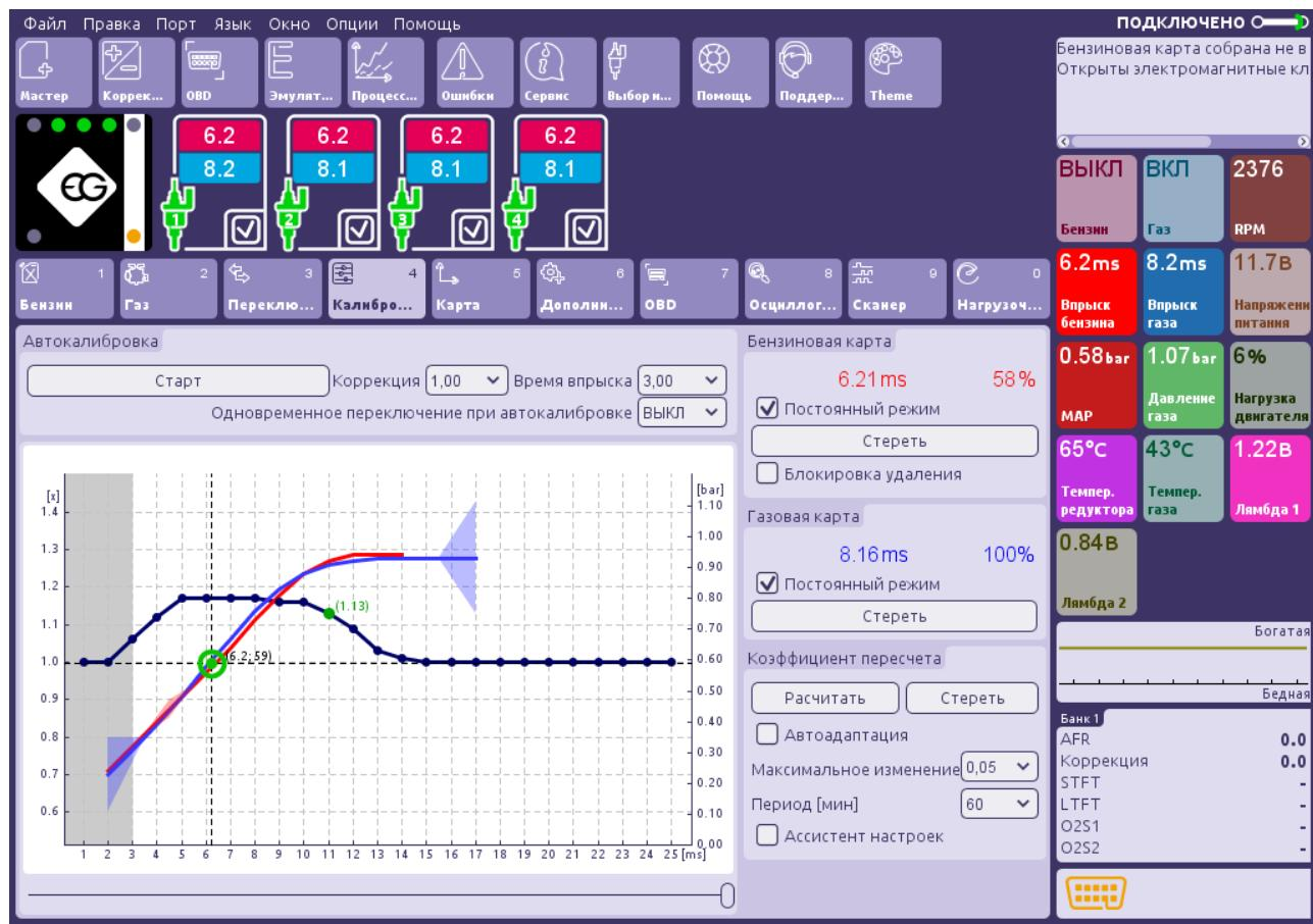
Карта в закладке **"Калибровка"** показывает зависимость времени открытия [ms] бензиновых инжекторов на бензине (красные точки) и времени открытия бензиновых инжекторов на газе (голубые точки) связаны со значениями абсолютного давления в коллекторе (вакуум) во впускном коллекторе двигателя [kPa]. С правой стороны закладки калибровки есть указание бензиновой (красный цвет) и газовой карты (синий цвет) буфера [%].
