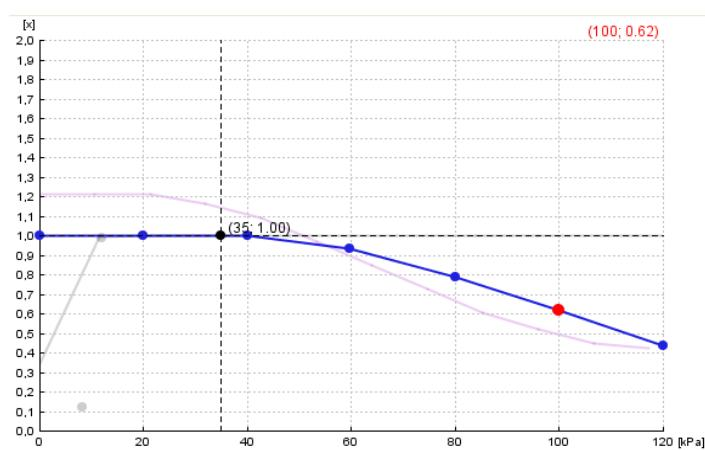
Коррекция Множителя (на пример. 1.0 на 100%, 0.6 на 60% первоначального смещения) от угла относительно абсолютного давления двигателя в коллекторе (нагрузки на двигатель). Для тяжёлых нагрузок рекомендуется выбрать регулировку ниже 1.0 чтобы не увеличивалось значение стука двигателя.
