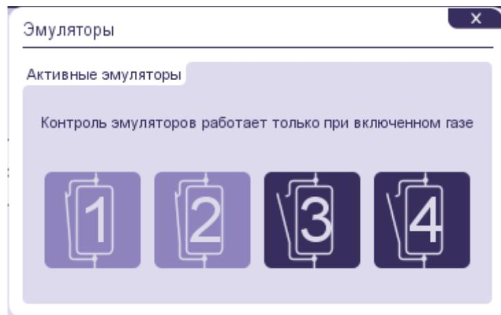
Показывает окно эмуляторной диагностики бензиновых инжекторов. Возможно закрывать и открывать цепь эмуляции бензинового впрыска в целях диагностики.
