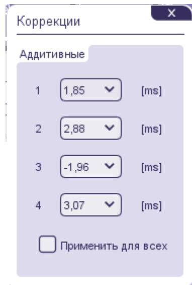
Показывает добавочное окно коррекций. Значение данной корректировки [ms] добавляется к времени открытия бензинового впрыска когда автомобиль на газе. Это значение устанавливается автоматически с помощью программного обеспечения во время процесса автокалибровки.
