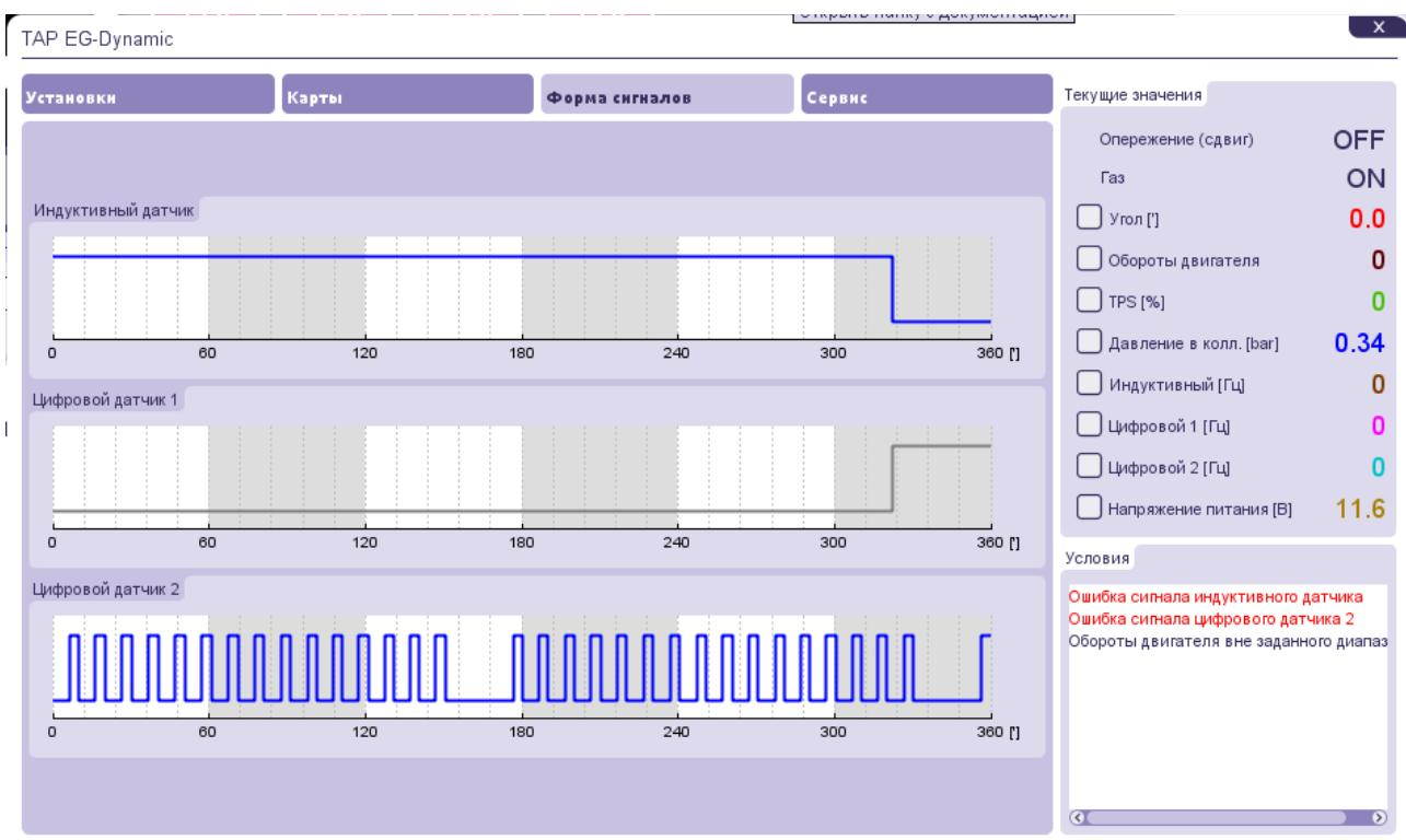
В этой закладке мы можем просмотреть форму сигналов каждого сканированного сигнала датчика.
