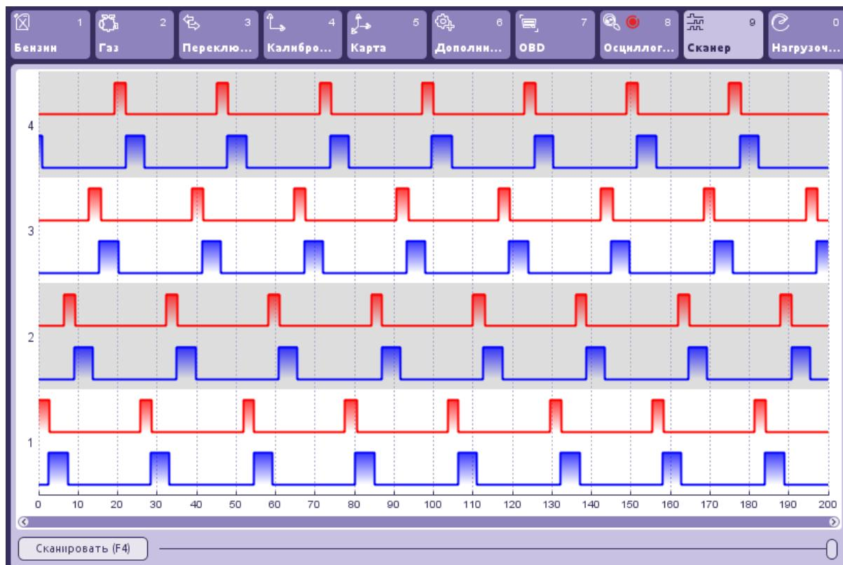
Осциллографический сканер впрыска бензина и газа это инструмент полезный для диагностических целей. С использованием данного сканера можно проверять: порядок последовательности впрыска, появление перекрытия инжектора, наличие коротких преимпульсов впрыска итд.
