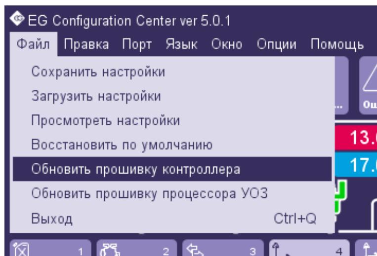
3. Следует выбрать файл с последней версией файла прошивки для нашего контроллера. После успешной проверки файла прошивки нам будет предложено подтвердить процесс обновления. Нам следует подтвердить, нажав кнопку "Да".
