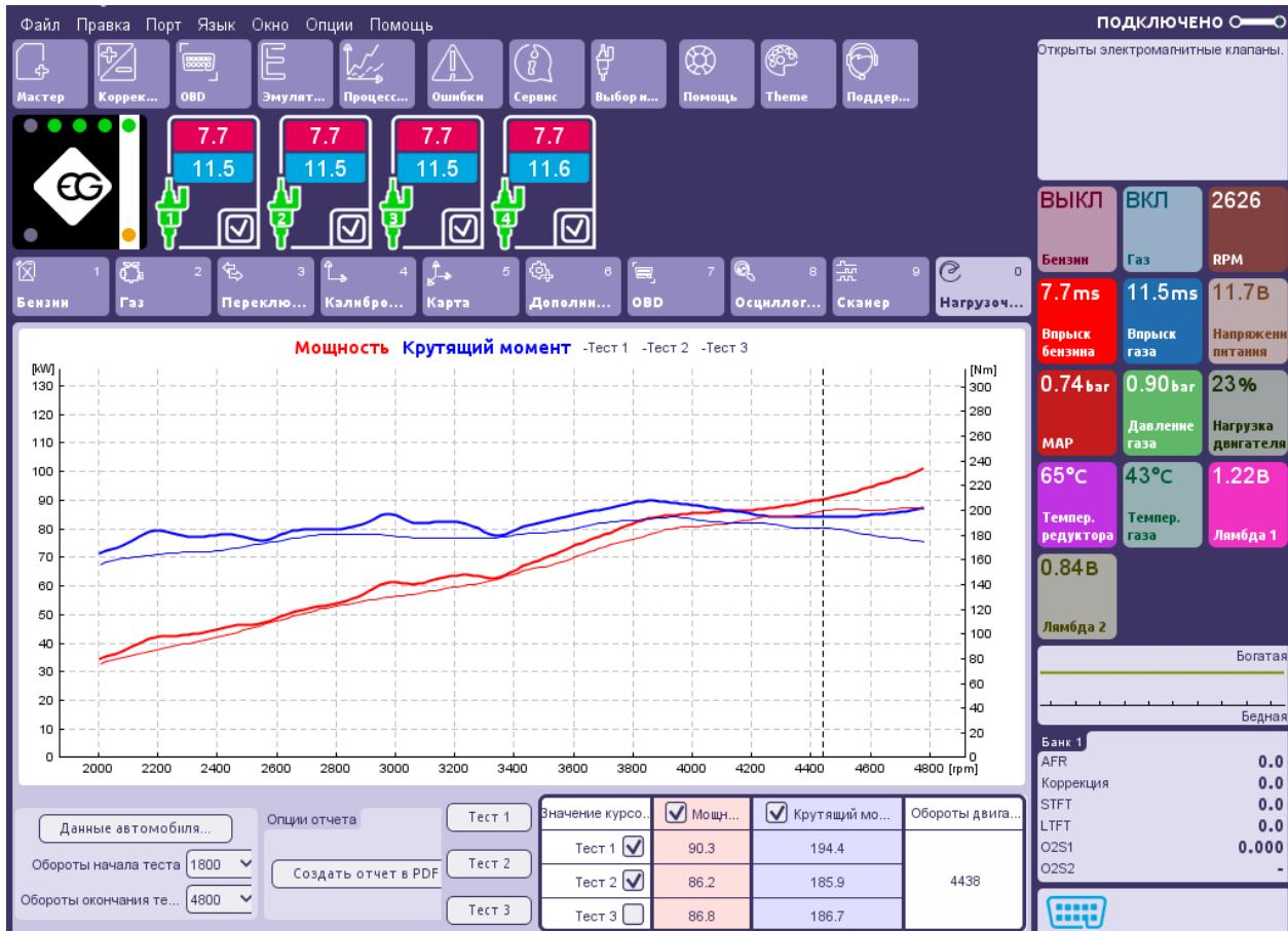
Реализованный модуль Нагрузочного Теста позволяет измерять мощность и крутящий момент двигателя автомобиля во время тест-драйва.
