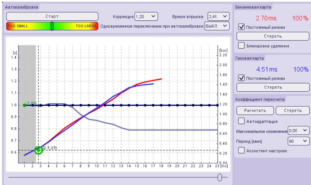
**Вкладка „калибровка“ с собранными бензиновыми и газовыми картами вместе с дополнительным множителем быстрой самонастройки в фоневом режиме.**
