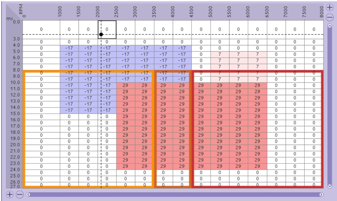
Для точной настройки состава смеси при включенной функции экстра впрыска используется маркер EPT. Маркер EPT отмечено оранжевым цветом. Позиция курсора на карте показывает, какое время инъекции необходимо изменить, чтобы изменить состав смеси, когда активна функция экстра впрыска бензина.
