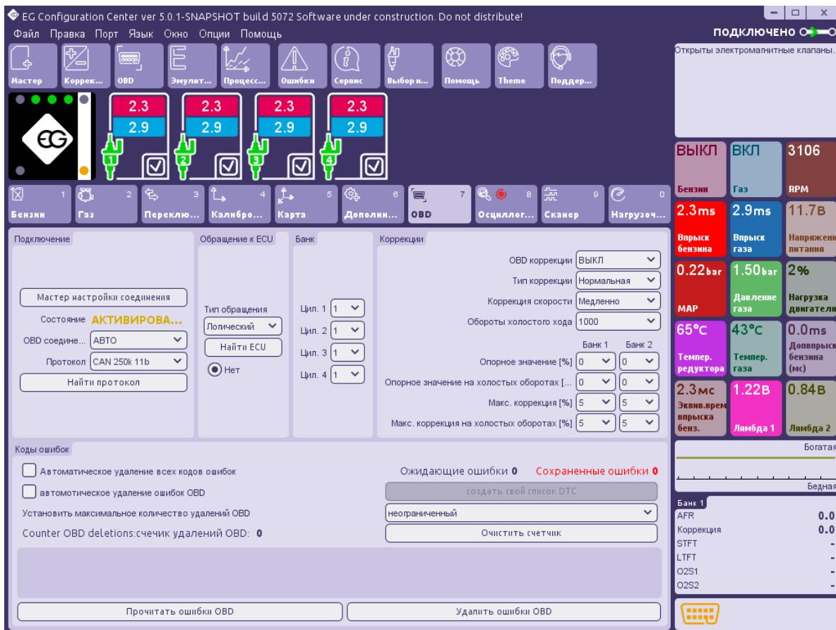
Настоятельно рекомендуется нажать на кнопку "Мастер подключения" для гладкой установки соединения с OBD. Мастер Подключения это обучение, которое полезно при проведении всех необходимых действий, требуемых для связи с бензиновым ЭБУ (например. инициализация соединения, нахождение протокола OBD, получение адреса ЭБУ, выбор PID для чтения газовым ЭБУ).
