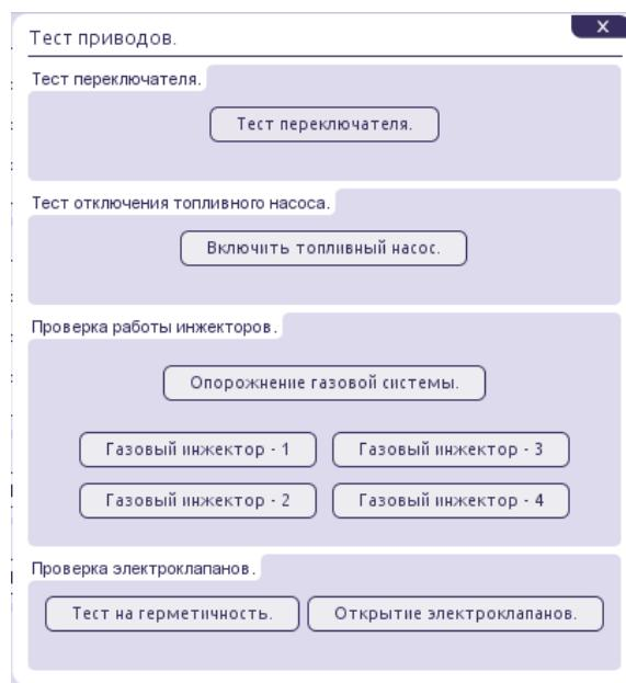
Набор функций, включенный в этот блок позволяет на диагностику компонентов и безопасную работу при обслуживании газовой системы.
