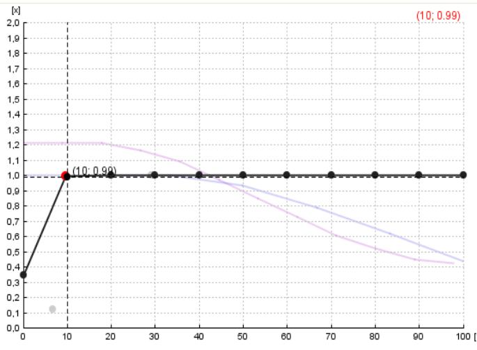
Коррекция Множителя (на пример. 1.0 на 100%, 0.6 на 60% первоначального смещения) от угла относительно значения сигнала TPS. Для условий холостого хода сигнальные импульсы смещения должны быть отключены, т. к. это может привести к махающимся двигателям RPM в некоторых типах автомобилей. Можно это делать путём снижения линии множителя на карте или в Панели настроек.
