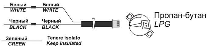
**Схема для подключения и эмуляции Лямбда-зонда**
