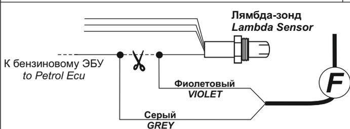
**Схема подкл. Программируемого провода**
